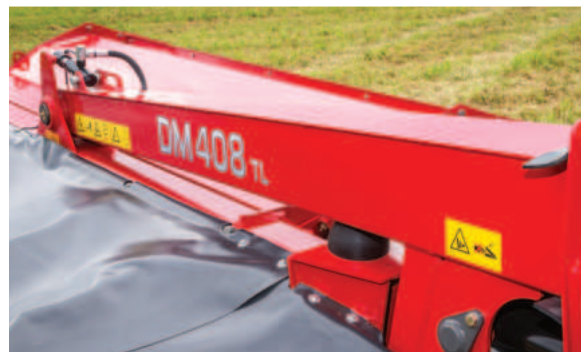
Centralni oslonac sa hidrauličnom amortizacijom nagiba
