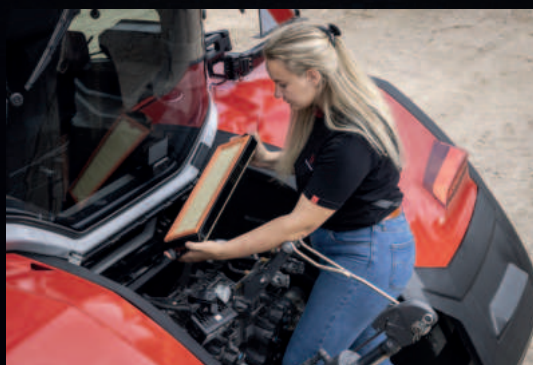
Lak pristup za vađenje vazdušnog filtera kabine radi čišćenja
