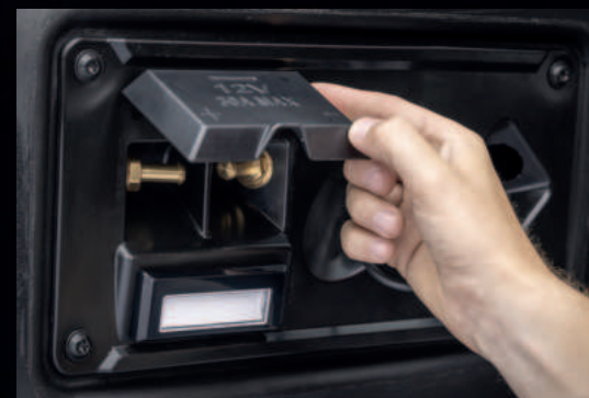
Sa opcijom paketa za profesionalce dobijate dva električna utikača od 12 V ugrađena na rezervoar za gorivo za napajanje eksterne pumpe za gorivo ili AdBlue®.
