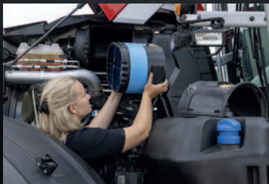
Vazdušni filter na motoru je veoma pristupačan i lako ga je očistiti
