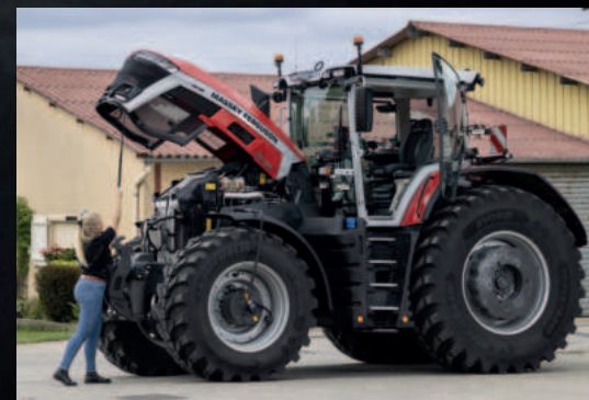
Prednja osovina i strukiran dizajn haube omogućavaju lakši pristup meraču nivoa ulja i filteru
