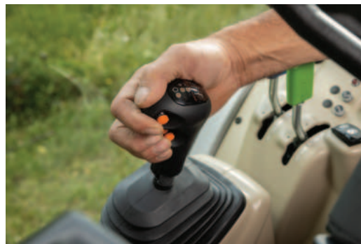
▲ Nova ručica za promenu brzine sa bovden sajlom za ugladen rad.
