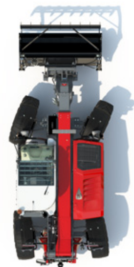
REŽIM POLU-BOČNOG HODA sa zadatim uglom zadnjeg točka – korisno za primene kao što su silaža ili čišćenje objekta.
