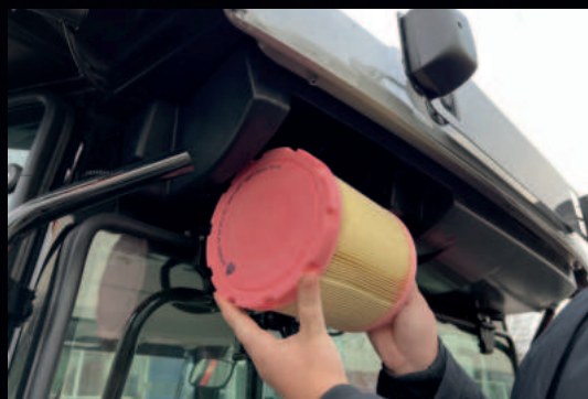
Lak pristup za uzimanje vazdušnog filtera kabine radi čišćenja.
