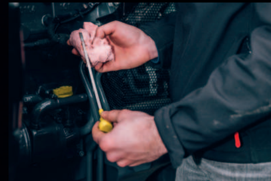
Prednja osovina i strukiran dizajn haube omogućavaju lakši pristup meraču nivoa ulja.
