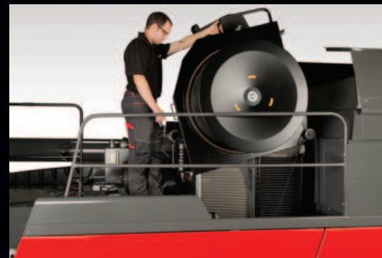
Bezbedan i lak pristup za čišćenje hladnjaka
