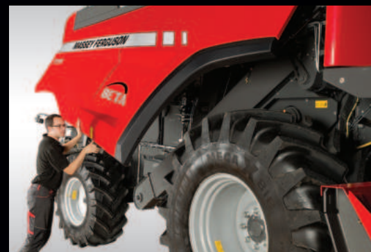
Jednodelni paneli sa svetlima omogućavaju brz pristup za održavanje
