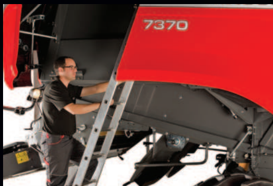
Bezbedan odeljak motora i pristup bunkeru zrna sa uklonjivim stepenicama
