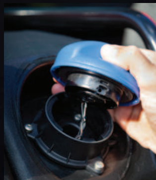
Rezervoar za AdBlue® je pažljivo postavljen i dobro izolovan od visokih i niskih temperatura. Punjenje oba rezervoara je sigurno i jednostavno.
