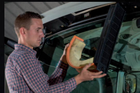
Vazdušni filter u kabini može se jednostavno skinuti i očistiti.
