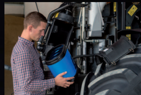
Kompaktan sistem za hlađenje je veoma pristupačan, lako ga je očistiti i održavati. 90% prašine se uklanja prirodnim putem zahvaljujući usisivaču na ventilatoru za hlađenje. Vazdušni filter na motoru je veoma pristupačan i lako ga je očistiti.
