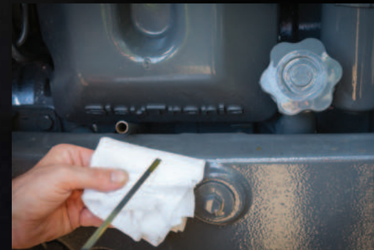
Poseban oblik haube i dizajn prednje osovine omogućavaju lak pristup filterima za ulje na motoru i meraču nivoa ulja.
