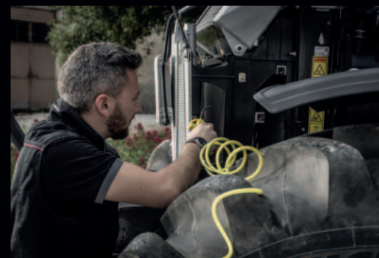
Paket za hlađenje je lako dostupan kako bi čišćenje bilo brže i lakše.
