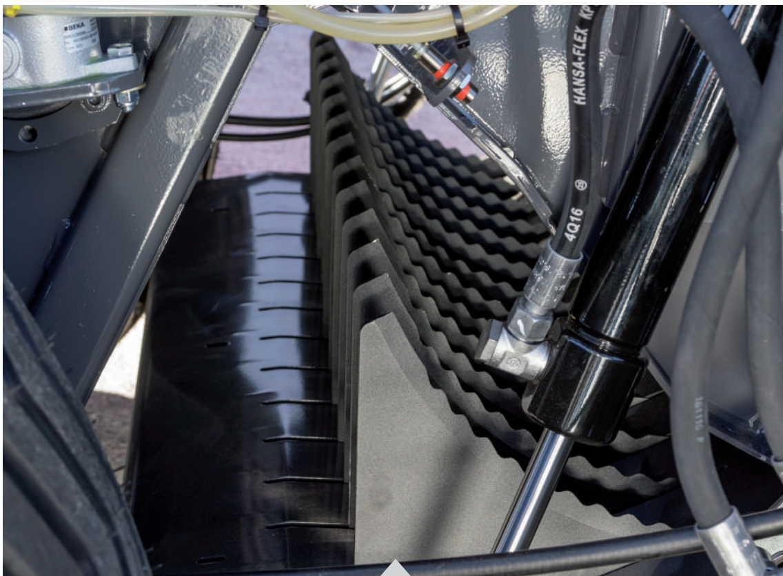
Xtracut 13 rotor seče masu na dužinu od 90 mm
